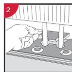
Taladre agujeros dos veces más grandes que el diámetro de las tuberías. Retire una pieza del panel con un cuchillo multiusos. Coloque el panel en un lado de los tubos y la pieza removida en el otro lado.
