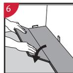
Coloque el tablón y el ángulo contra el tablón en la fila anterior, presione hacia adelante y doble hacia abajo al mismo tiempo. Deje el tablón en una posición algo inclinada hacia arriba cuando los tabloncillos comiencen a encajarse. Para hacer esto aún más fácil, se puede colocar una cuña con el ángulo adecuado debajo del tablón cerca de la junta del lado corto como apoyo.
