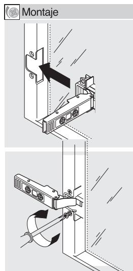
Adaptar las medidas de elaboración a los distintos espesores del material. La cazoleta de bisagra debe poder apoyarse en el borde fresado
