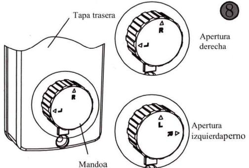
Nota: Al instalar la carcasa trasera, asegúrese de distinguir las direcciones de apertura izquierda y derecha. La marca R de la perilla está hacia arriba cuando se abre hacia la derecha y la marca L está hacia arriba cuando se abre hacia la izquierda.
