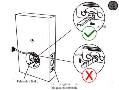
Al instalar la superficie de la cerradura delantera, la lengüeta de la cerradura del cuerpo no debe sobresalir y la dirección de la paleta del cilindro de la cerradura debe ser vertical.
