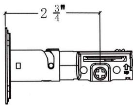
Ajustando la distancia entre ejes del cuerpo de la cerradura, éste puede adaptarse a centros de 2 3/4" (70mm) y 2 3/8" (60mm)
