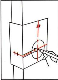
El calibre del papel está alineado en un lado con el borde de la puerta y el agujero central de la manilla suele estar a 39" del suelo. Coloque el centro de la cerradura en la puerta (existen tamaños de 2 3/8" y 2 3/4" desde el borde de la puerta hasta el centro de la cerradura) Cut holes in the facade and side according to the position specified in the paper
