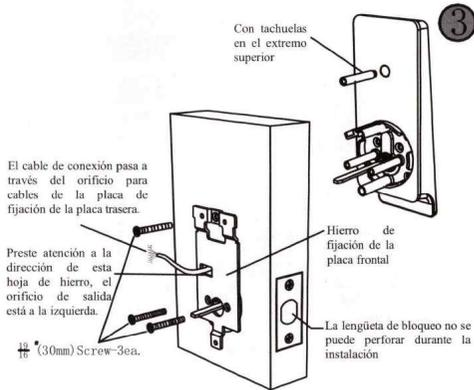
El cable de conexión pasa a través del orificio para cables de la placa de fijación de la placa trasera.
