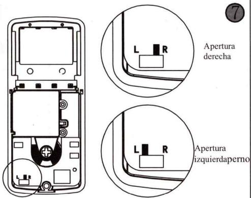
Mueva el interruptor a la posición R o L según la dirección de apertura de la puerta
