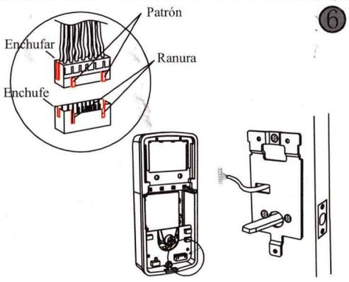
Nota: la dirección no se puede invertir, la protuberancia del enchufe debe estar alineada con la ranura del enchufe
